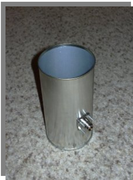
obrázek 1: ukázka použité antény
