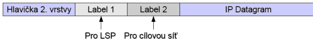
Ilustrace 6: Pouzdření návěští u MPLS Layer-3 VPN
