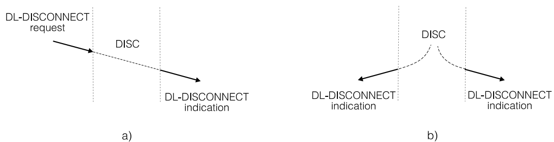
Obrázek 14.8: Rozpojení logického spoje
